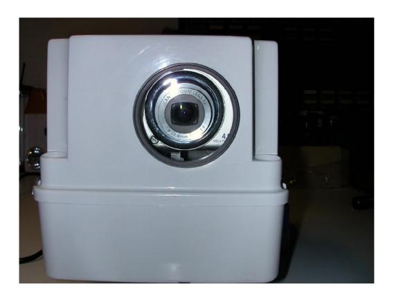
Piccola inesattezza a proposito della prima cosa da fare... una volta stabilito dove sarà il nostro obiettivo, ne consegue che anche la fotocamera troverà la sua posizione all'interno della scatola per cui dovete simulare che questa fotocamera sia fissata e questa simulazione deve comprendere anche l'innesto dei cavetti relativi alla USB e all'alimentazione della Canon stessa.
