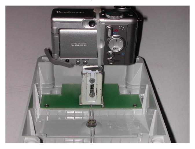
Nella foto qui sopra, è visibile il supporto alla fotocamera, è un braccetto di una vecchia tenda della Stanley, è possibile alzarla in verticale per metterla a giusta misura ed anche farla scorrere in orizzontale sulle asole da me fatte sulla contro piastra come si vede in foto allo scopo di avvicinarla quanto più possibile al vetro del filtro esterno.
