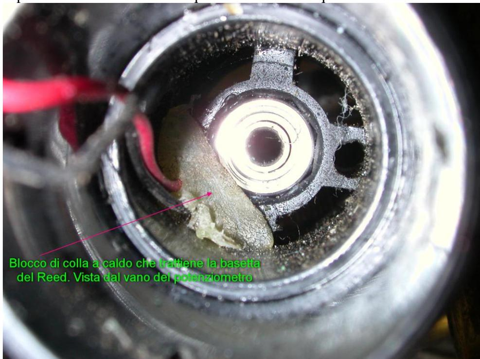
Con qualche utensile con la punta a forma di breve uncino, potete farlo con un robusto fermaglio da ufficio, iniziate a tirare via la colla facendo attenzione a non danneggiare la basetta del Reed. Qualcuno ha suggerito di mettere per il tempo necessario tutto il blocco del Vano in un Freezer a -20° così che poi la colla si toglie facilmente, io, magari con più tempo, ho usato il metodo dell’uncino....
